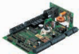
Cobra 5000 Plus Поставляется со стабилизированным блоком питания и корпусом LM (IP55)
