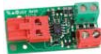
Шинный интерфейс XIB (для платы E045 или E024S с фотоэлементом без возмож- ности подключения к шине)
