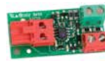
Шинный интерфейс XIB (для платы E045 или E024S с фотозлементом без возможности подключения к шине)
