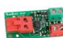
Шинный интерфейс XIB (для платы E045 или E024S с фотоэлементом без возмож- ности подключения к шине)
